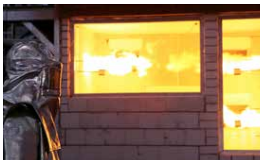
Brandschutzgläser widerstehen im Ernstfall bis zu 120 Minuten den Flammen und bleiben dabei durchsichtig – entscheidend für eine sichere Evakuierung.
