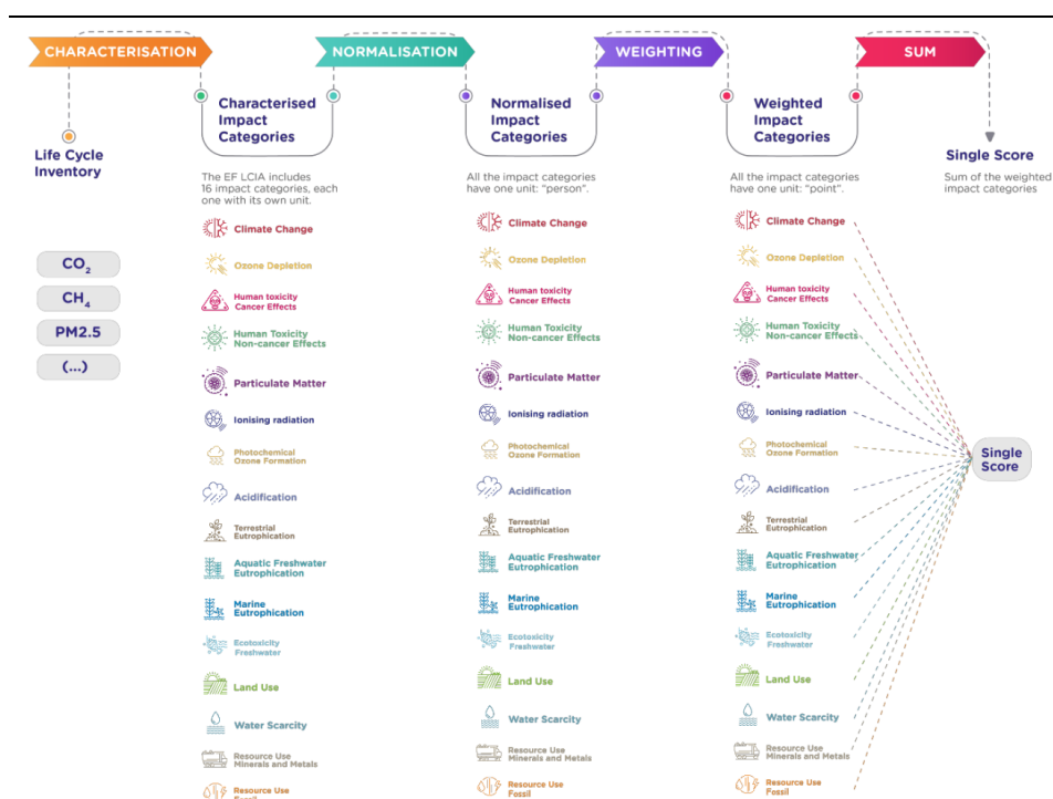
Abbildung 7: Schema der EF Methode (Grafik aus Andreasi Bassi, S u. a., 2023)
