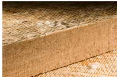
*Eine Dämmung aus Glasfasern muss theoretisch nie ersetzt werden. Auch nach Jahrzehnten im Einsatz lassen die Dämmeigenschaften nicht nach.*
