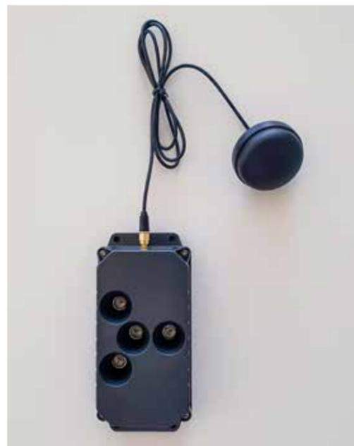
*Il sensore misura la distanza dal contenuto del container al livello di riempimento massimo.*
