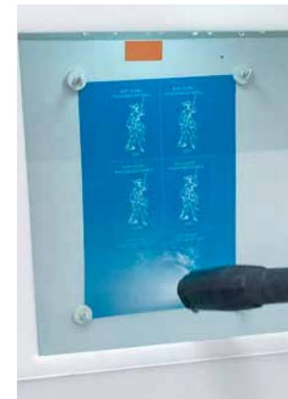
une machine d'exposition est nécessaire. Le modèle est déposé à l'aide d'une pompe à vide sur un film et exposé. On ne voit encore rien. Il faut quelques minutes d'arrosage avec un nettoyeur haute pression pour que le motif apparaisse. «On peut ainsi appliquer des photographies ou des écritures très fines sur le verre», raconte le collaborateur Tom Corpataux. L'étagère de vente le montre: des animaux aux arbres, en passant par des textes de plusieurs lignes, tout est effectivement possible.
