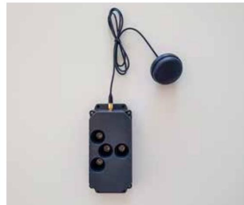
Le capteur mesure la distance entre le contenu du conteneur et le niveau maximal de remplissage.
