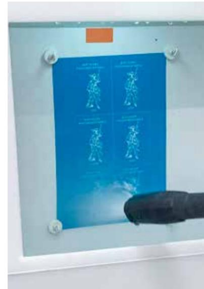
Vakuumpumpe auf eine Folie gepresst und belichtet. Noch sieht man nichts. Erst nach einigen Minuten Bewässerung mit einem Hochdruckreiniger wird das Muster sichtbar. «Auf diese Weise lassen sich sogar Fotografien oder ganz feine Schriften auf Glas applizieren», erzählt Mitarbeiter Tom Corpataux. Das Verkaufsregal zeigt: Von Tieren über Bäume bis zu mehrzeiligen Texten ist tatsächlich alles möglich.
