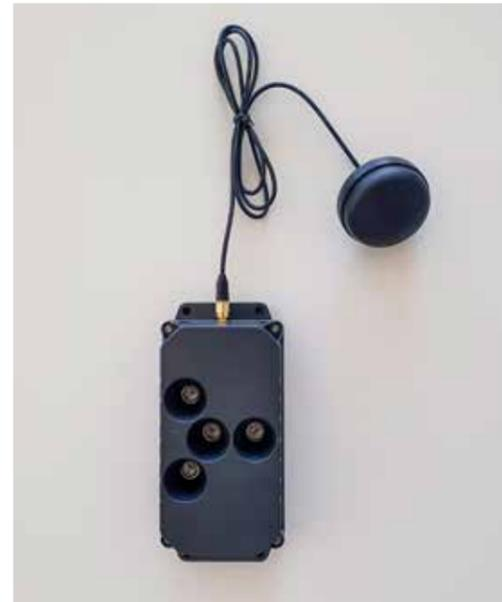
*Der Sensor misst die Distanz vom Inhalt des Behälters bis zum maximalen Füllstand.*
