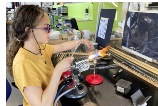
Roberta Clemente dà un assaggio delle abilità fondamentali di questa professione: riscalda il tubetto di vetro e la bacchetta...
