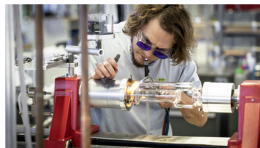
Herstellung einer Soxhlet-Extraktionskammer: Mit diesem Gerät wird zum Beispiel der Fettgehalt eines Lebensmittels im Labor bestimmt.
