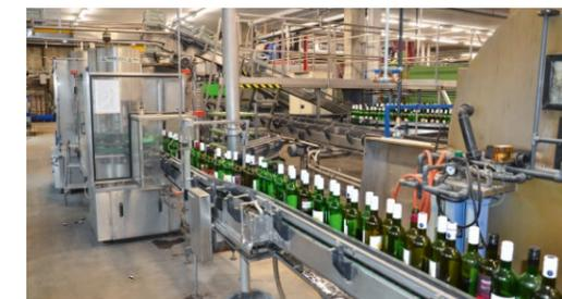
*Les bouteilles passent par une installation de triage optique avant d'être lavées. Les bouteilles mises au rebut ou brisées sont transformées en bouteilles neuves par Vetropack.*
