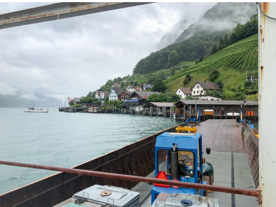
Bei tiefem Wellengang ist der Warenumschlag mit Gabelstapler und Traktor möglich. An stürmischen Tagen hilft sich Schiffführer Scherrer mit einem kleinen Kran aus.
